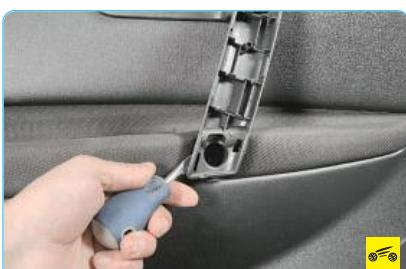
4. Подденьте отверткой облицовку и, преодолевая сопротивление фиксаторов...
