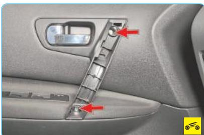
3. Выверните два винта крепления облицовки внутренней ручки к кронштейну монтажной панели передней двери.
