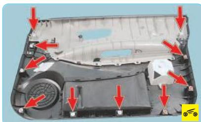
**Обивка двери (вид с обратной стороны) прикреплена к панели двери десятью пластмассовыми пистонами. Поврежденные пистоны замените новыми, вынув их из кронштейнов обивки.**
