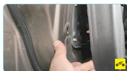
7. ...затем, преодолевая сопротивление фиксаторов, отделяйте обивку от внутренней панели двери...
