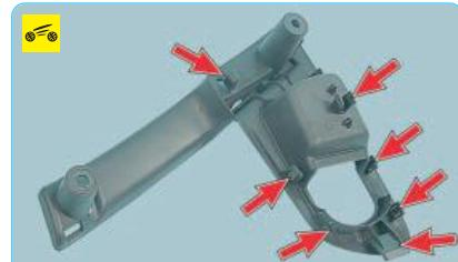
**Обратите внимание на фиксаторы с обратной стороны облицовки. При повреждении фиксаторов замените облицовку внутренней ручки.**
