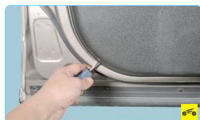
6. Подденьте отверткой обивку передней двери в ее нижней части...
