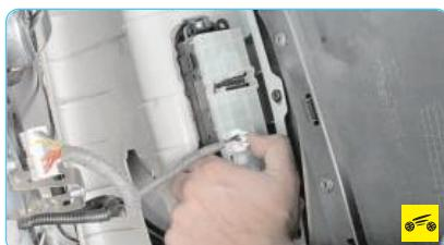
11. Нажмите на фиксатор колодки жгута проводов клавиши блокировки электростеклоподъемников дверей...
